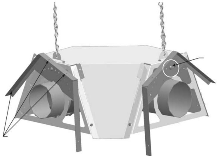
4. Alignez un des trous dans l'adaptateur d'angle avec le centre de trou en haut du cintre
